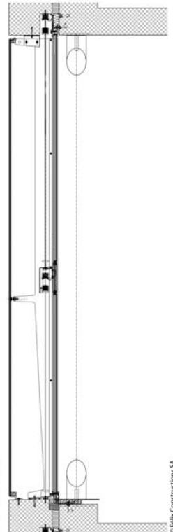
Les verres extérieurs sont alignés sur les dalles et fixés en haut et en bas par un silicone. Sur la double hauteur, une fixation VEA lie le verre à la lame en acier. Les stores occupent l'espace intérieur.
